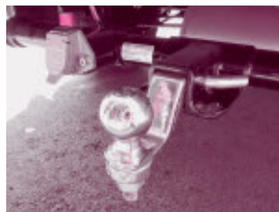
▲ボート結合部
