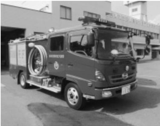
この車両は、東消防署に配置されていて、火災の初期段階に必要な消防用水（1,500ℓ）を積載しています。水を積んでいることから、通称「タンク車」と呼ばれています。火災の直近に配置し、消火栓や防火水槽などの水利を利用しなくても、素早く消火活動が行える車です。積載されている機材は、ホースが40本、ホースの延長に使用する電動ホースカーや空気呼吸器、約9m伸長できる三連梯子、排煙機など、消火活動に必要なたくさんの機材が積載されています。また、「緊急消防援助隊・消火部隊」に登録されていて、大規模災害が発生し出動要請が入れば全国へ派遣されます。
