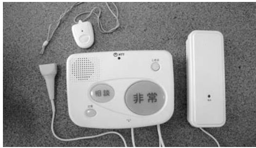
緊急通報装置
