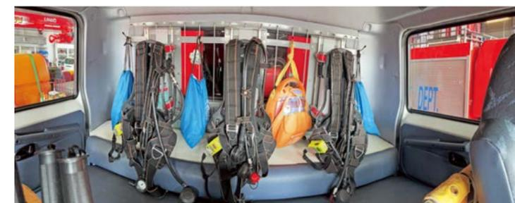
後部座席には、空気呼吸器が積載されており、火災現場へ出動している途中で呼吸器の装着や取り外しが簡単にできるようになっています。
