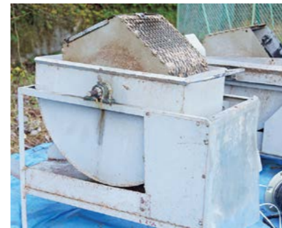
▲サトイモの土やひげ根などを取り除く特注の水車型の機械。電気と水の力で機械を回転させてサトイモをきれいな状態にしていきます。
