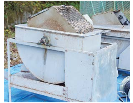
▲サトイモの土やひげ根などを取り除く特注の水車型の機械。電気と水の力で機械を回転させてサトイモをきれいな状態にしていきます。
