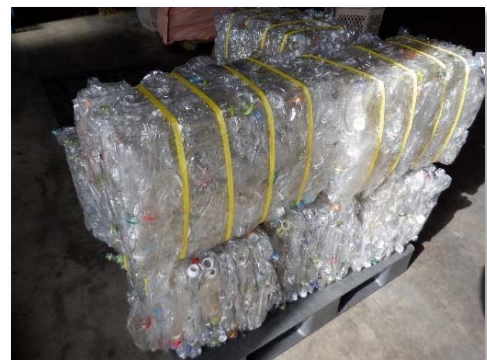
大宮地方環境整備組合 環境センター ペットボトルの圧縮梱包
