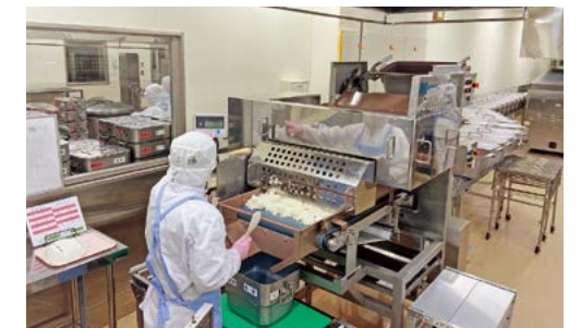
▲全長10mにもなるガス式コンベアを流れながら、 ご飯が炊き上がっていきます。
