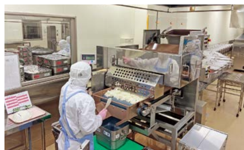
▲全長10mにもなるガス式コンベアを流れながら、ご飯が炊き上がっていきます。
