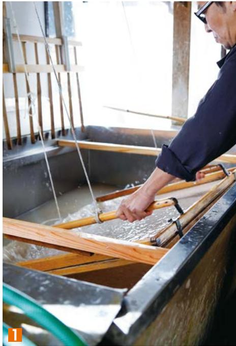
**1** 商品によって紙すきの水の流し方が変わると大輔さん。写真では、質桁から縦に水が流れて出ていることがわかります。**2** 楮の節や固い繊維などを取り除く「ちりとり」の作業は妻が担当。取り除いたものは固い部分が入っていても品質に影響がない商品に再利用します。**3** 取材中、糸に加工する和紙を仕入れに来客がありました。2mmほどに切って糸に加工したあとは、着物の帯などに使用するとのことです。
