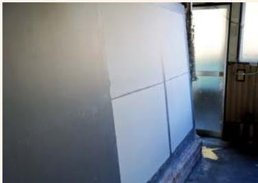
金属板の乾燥用機械に紙を貼り付け、熱して乾燥します。板に張り付いていた側が紙の表側になります。
