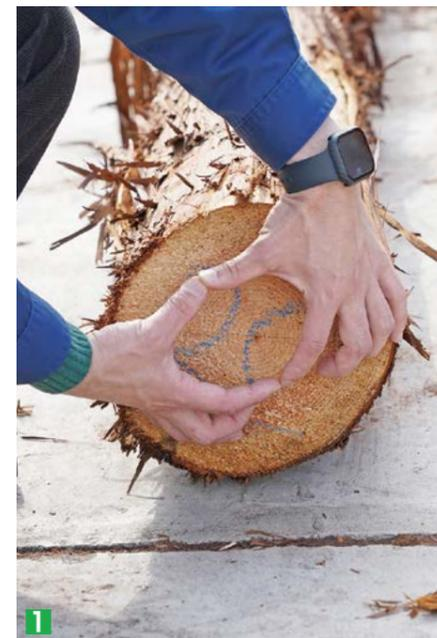
1 丸太 1 本から手で囲んでいる太さの角材が作られます。切り落とした周りの部分は板材や木材乾燥機の燃料などになります。2 丸太を機械でカットする様子です。製材作業のほとんどは機械によって行われます。3 節の有無などによって木材を仕分けるのは人の目で行います。「品質が一番の売りなので、ここだけは人の目が欠かせません」と野上会長。
